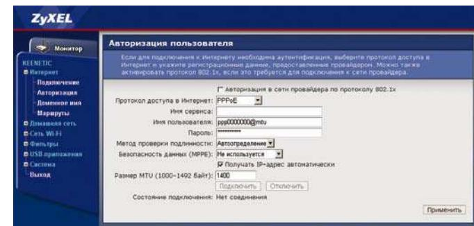
После применения настроек интернет-центр будет самостоятельно устанавливать PPPoE-подключение с провайдером через ADSL-модем, и вы сможете выходить в Интернет с любого компьютера или устройства домашней сети. Рекомендуется удалить с компьютера сетевое подключение, использующее мини-порт WAN (PPPoE), или специальное программное обеспечение (PPPoE-клиент), которым вы пользовались ранее для подключения к Интернету.
