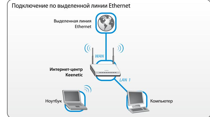
Для организации домашней сети вы можете использовать встроенную точку доступа Wi-Fi и четыре разъема «LAN». Все подключаемые устройства должны быть оборудованы сетевым адаптером Wi-Fi или Ethernet, интернет-центр по протоколу DHCP автоматически назначит им параметры IP. Общие рекомендации по работе в беспроводной сети приведены на стр. 22.
